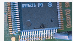
4. Bauteil an 1 Lead fixieren, Position überprüfen, danach diagonal an 2. Lead fixieren.
