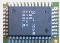
6. Fertig - mit gleichmäßig ausgeformten Lötstellen
